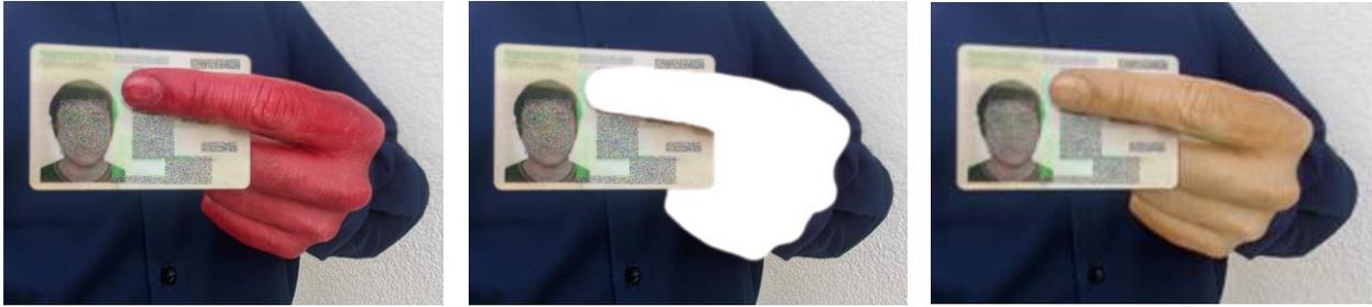
Abbildung 12: Segmentierung anhand rot eingefärbter Bereiche. Die Original-Hautfarbe wird durch Verschiebung des Farbtons innerhalb des Segmentes wiederhergestellt.
