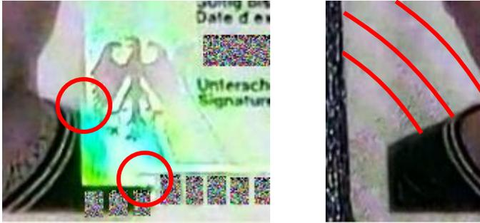
*Abbildung 14: Artefakte an der unteren linken Ecke eines Hologramms durch Abweichungen in dessen Positionierung auf dem Quell- und Ziel-Dokument (links); diese Artefakte verschwinden nach manueller Positionskorrektur. Artefakte durch Abfilmen von einem Fernsehbildschirm (rechts); diese Artefakte verschwinden bei Abfilmen von einem Videoprojektor.*
